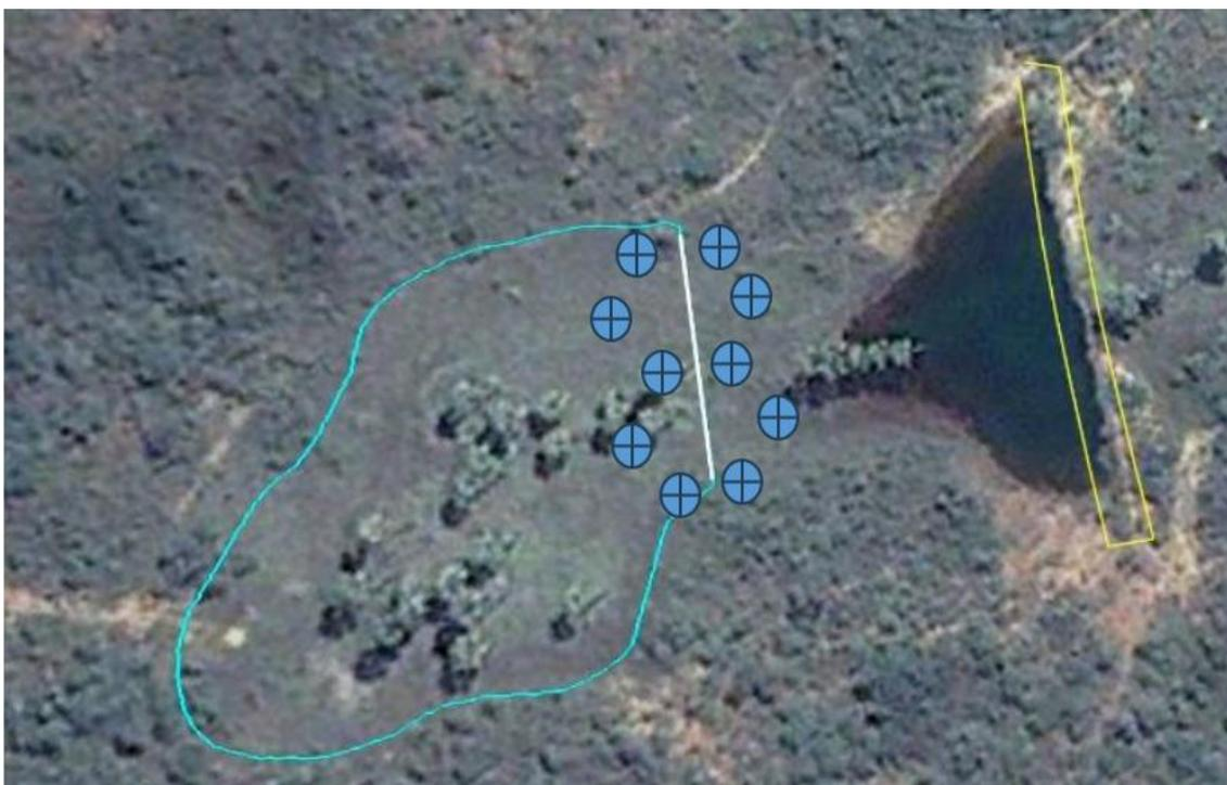
**Figura 2: ⊕ Localização dos locais de instalação dos poços a montante e a jusante para monitoramento do LF**
